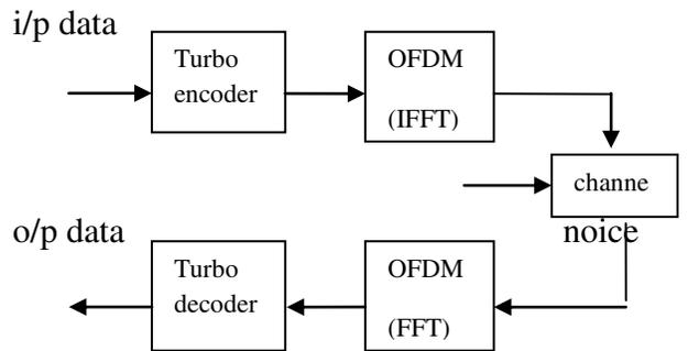
FIG 4 TURBO CODED OFDM SYSTEM
