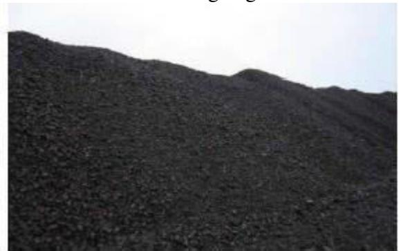
Fig.1. Copper slag
