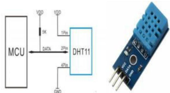
Fig 4: DHT11 Sensor
