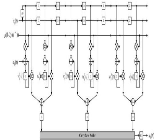
FIG 2: Infomax filtering module.
